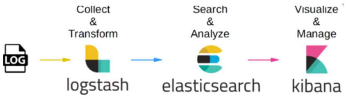
Gambar 2.2.3.6.5. Hubungan antar Stack pada ELK
